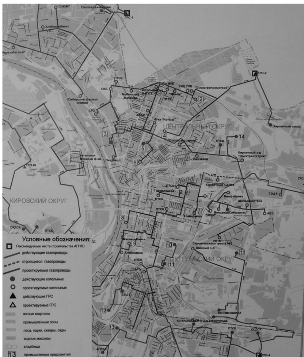
Рис. 1. Возможное расположение АГНКС применительно к инфраструктуре газификации города Омска и транспортным магистралям
