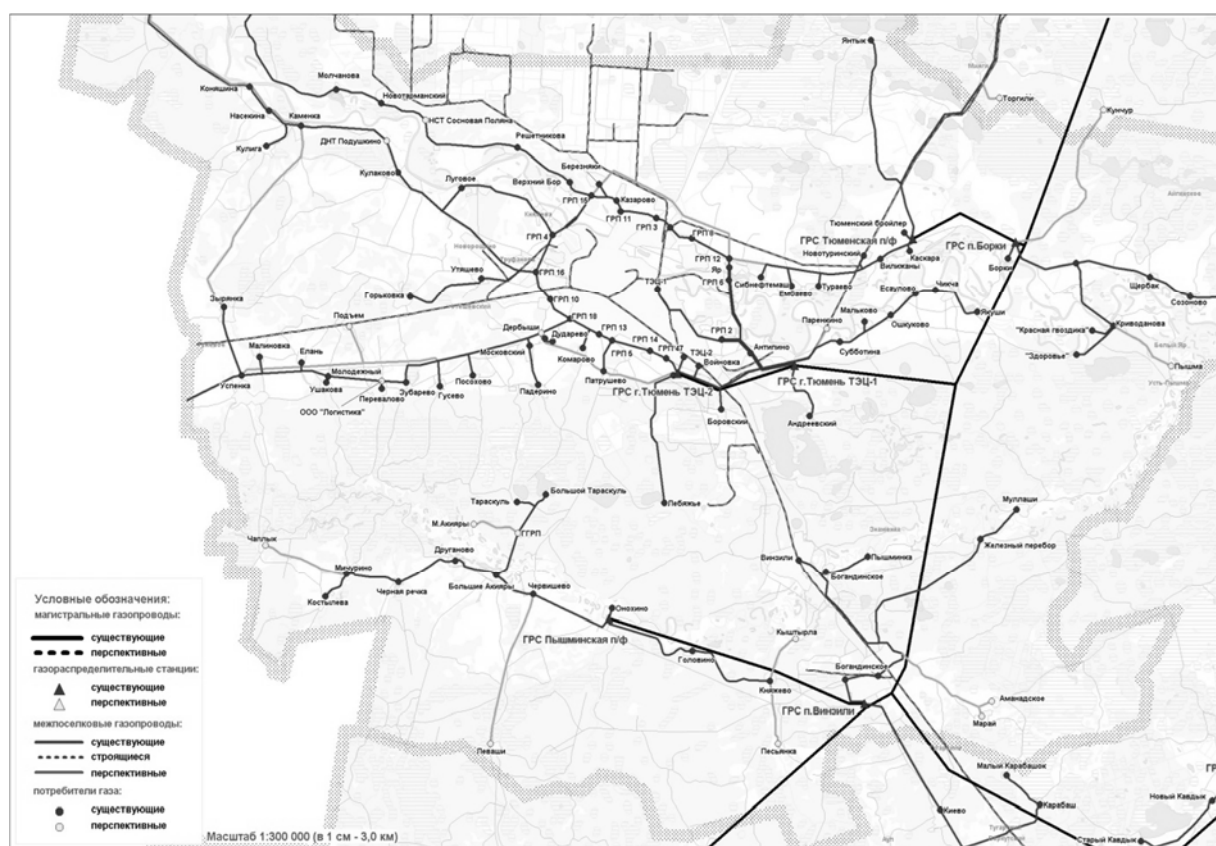
Рис. 1. Схема газоснабжения и газификации г. Тюмени
