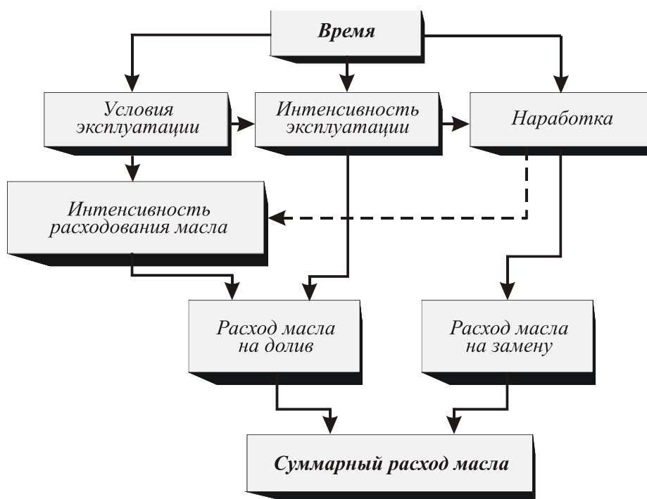
Рис. 3. Предлагаемая система нормирования расхода моторного масла
