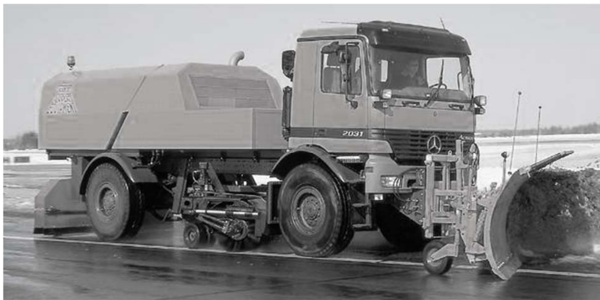
Рис. 3 Аэродромная компактная подметально-продувочная машина SCHMIDT тип CJS 914 Super II во время работы
