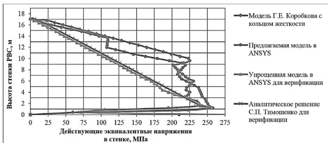
Рис. 3. Зависимости действующих эквивалентных напряжений в стенке РВСПК-50000 от величины взлива нефти
