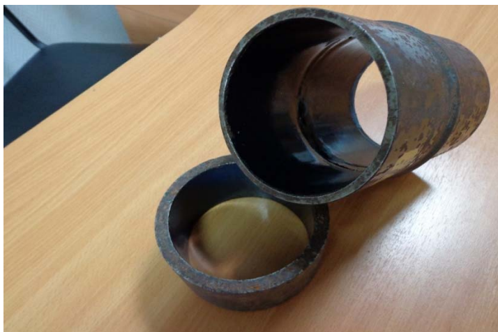
Рис. 3. Образец труб с внутренним стеклоэмалевым покрытием, сваренных методом контактной сварки
