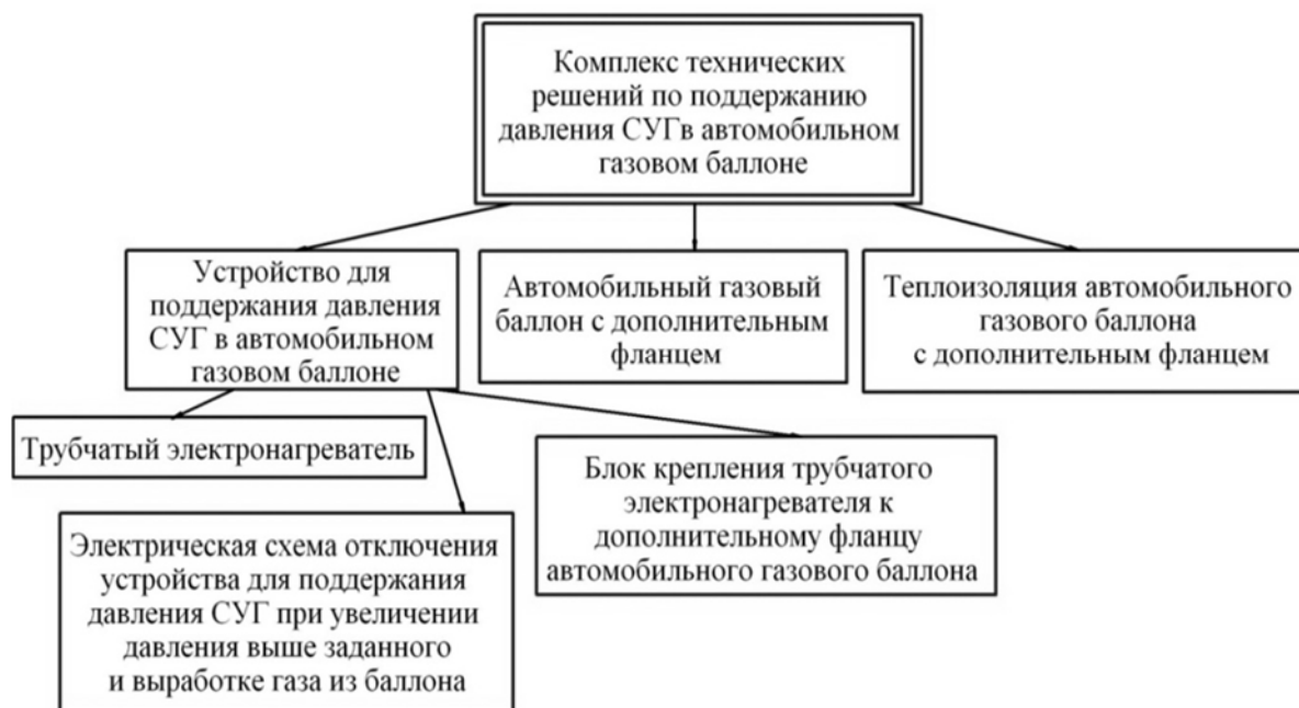
Рис. 1. Комплекс технических решений по поддержанию заданного давления СУГ в газовом баллоне
